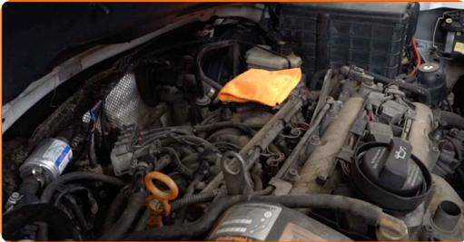
6 Løsne slangen for veivhusventilasjonen fra oljepåfyllingsstuss.
