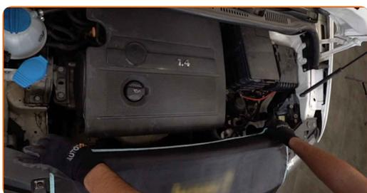
3 Løsne slangen for veivhusventilasjonen fra motordekselet til venstre.
