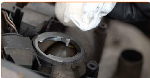
19 Monter oljepåfyllingsstuss. Skru inn oljepåfyllingsstuss.
