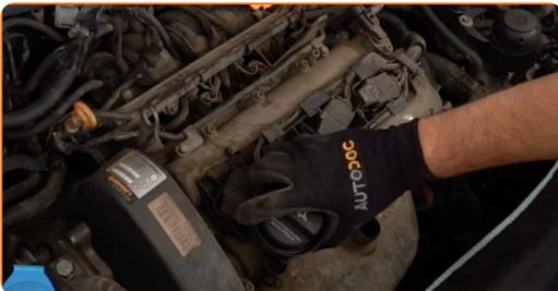
8 Dekk til påfyllingsstussen med en mikrofiberklut for å forhindre at smuss og fremmede objekter kommer seg inn i systemet.
