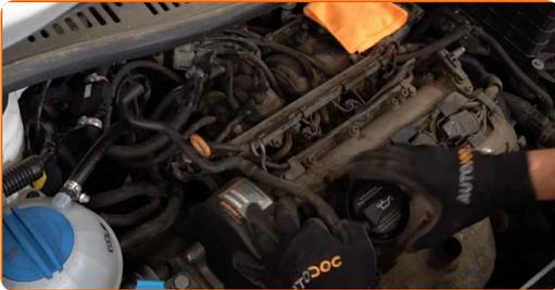
7 Skru løs oljepåfyllingsstuss. Fjern oljepåfyllingsstuss.
