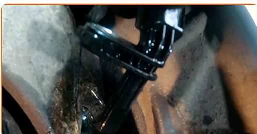
**10** Rengjør festepunktet til ABS-sensoren. Bruk en stålbørste. Bruk WD-40 spray.
