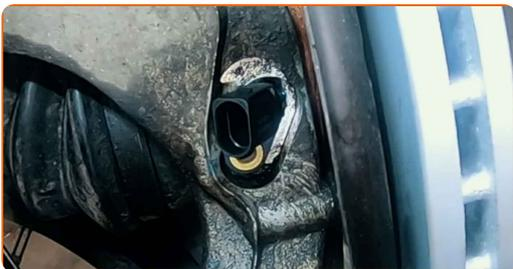
**13** Stram festene som forbinder ABS-sensoren med styrespindelen. Bruk HEX nr. H5. Bruk en momentnøkkel. Stram den til 7 Nm dreiemoment.
