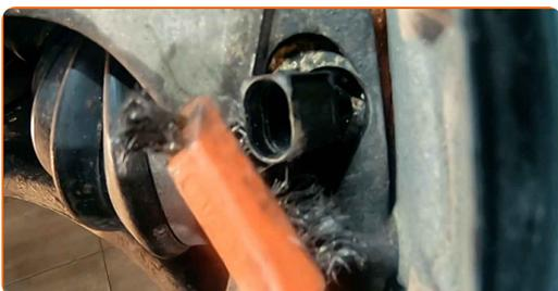
**8** Skru løs festet til ABS-sensoren. Bruk HEX nr. H5. Bruk en skrallenøkkel.
