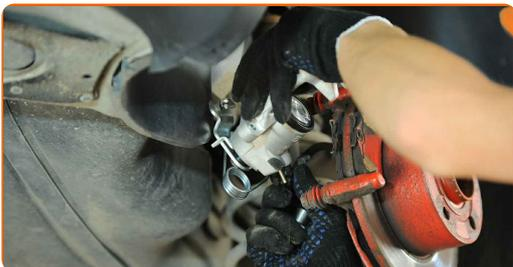
**18** Stram festene til bremsekaliperen. Bruk en kombinasjonsnøkkel #15. Bruk en pipenøkkelinnsats #13. Bruk en momentnøkkel. Stram den til 35 Nm dreiemoment.
