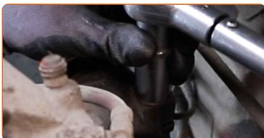
**71** Stram festene som kobler stabilisator-ledd til fjærbein. Bruk en pipenøkkelinnsats #18. Bruk XZN #6. Bruk en momentnøkkel. Stram den til 65 Nm dreiemoment.
