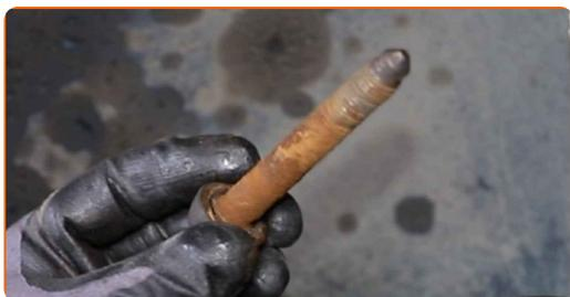
**25** Rengjør festene som kobler kuleleddet til styrearmen i hjulopphenget. Bruk en stålbørste. Bruk WD-40 spray.
