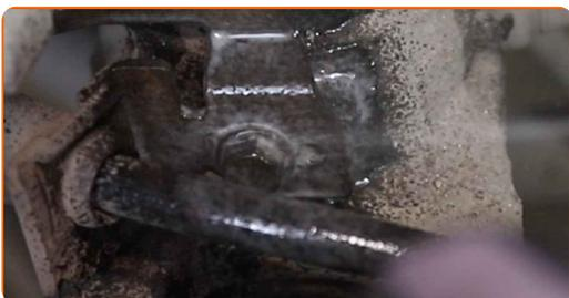
**20** Skru løs festet som forbinder braketten til bremseslangen med fjærbeinet. Bruk en kombinasjonsnøkkel #10.
