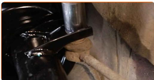
**70** Stram de nedre festene til fjærbeinet. Bruk en pipenøkkelinnsats #18. Bruk XZN #14. Bruk en momentnøkkel. Stram den til 70 Nm dreiemoment.+90°
