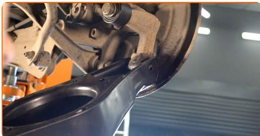
**Utskifting: nedre tverrgående bæream i opphenget bak – VW Passat NMS (A32, A33). Tips:**
