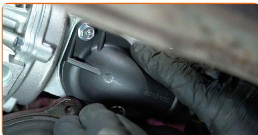
**13** Stram festene til termostathuset. Bruk en pipenøkkelinnsats #10. Bruk en momentnøkkel. Stram den til 13 Nm dreiemoment.
