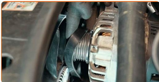
**15** Skru inn festet til strammerullen til klimaanleggets drivreim. Bruk en kombinasjonsnøkkel #17. Bruk HEX nr. H7. Bruk en skrallenøkkel.
