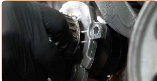
**Utskifting: vannpumpe & registerreimsett – VW Passat Variant (3C5).****AUTODOCs ekspertes anbefaler:**
