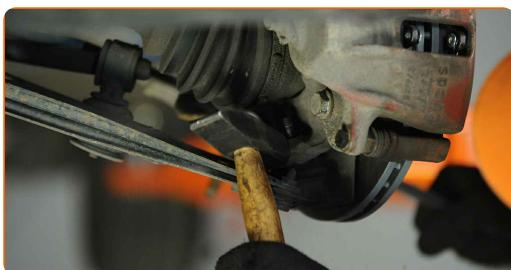
**12** Skru løs festene som binder kuleleddet til kontrollarmen. Bruk en pipenøkkelinnsats #13. Bruk en skrallenøkkel.
