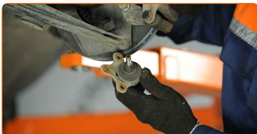
**15** Rengjør kuleleddets monteringsflate. Bruk en stålbørste. Bruk WD-40 spray.
