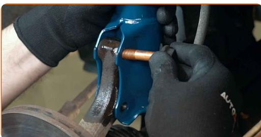
**40** Skru inn festene som kobler fjærbeinet til styrespindelen. Bruk en kombinasjonsnøkkel #18. Bruk en pipenøkkelinnsats #18. Bruk en skrallenøkkel.
