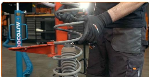
24 Ta av støtdemper-støvhetten og støtstopperen.
