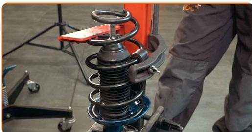
**30** Installer den øvre demperen og monteringslager.
