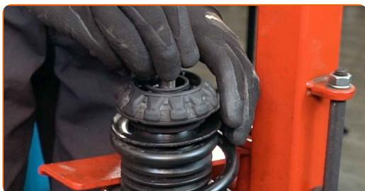
**31** Stram fjærbeinets stempelstangmutter. Bruk HEX nr. H6. Bruk en pipenøkkelinnsats #21. Bruk en momentnøkkel. Stram den til 60 Nm dreiemoment.
