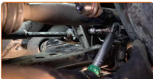
Utskifting: stabilisator foring – VW POLO (9N\_). AUTODOC anbefaler:
