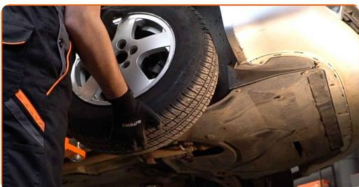
Utskifting: stabilisator foring – VW POLO (9N\_). Tips fra AUTODOCs eksperter:
