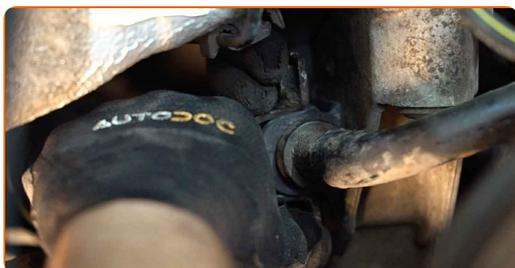
**15** Støtt armen. Bruk en hydraulisk jekk.
