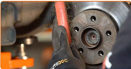
**20** Behandle overflaten hvor bremseskiven kontakter felgen. Bruk kobberfett.
