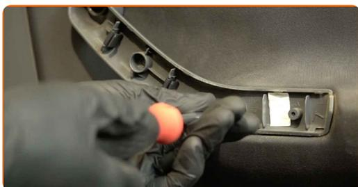
**4** Skru løs dørpanelfestene. Bruk en Philips-skrutrekker.
