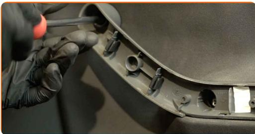
**5** Løs dørpanelet. Bruk et verktøy for trimming, plast.
