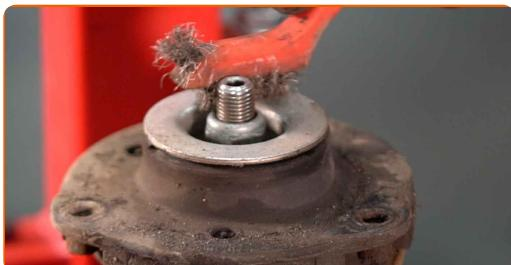
**30** Fjern mutteren på beinets stempelstang. Bruk en pipenøkkelinnsats #21. Bruk HEX nr. H6. Bruk en skrallenøkkel.
