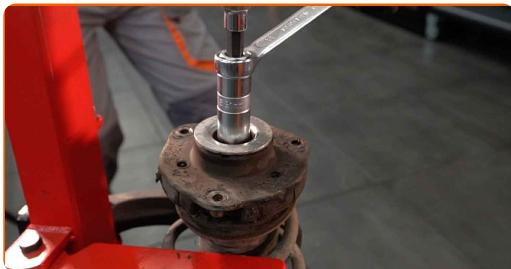
**31** Fjern støtdemperfestet, støvbeskytteren og støtstopperen.
