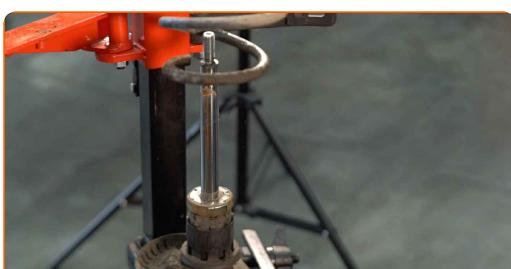
**34** Ta vekk den gamle støtdemperen fra den hydrauliske kompressoren.
