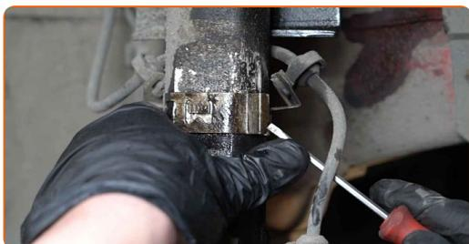
**17** Koble fra bremseslangen. Bruk et brekkjern.
