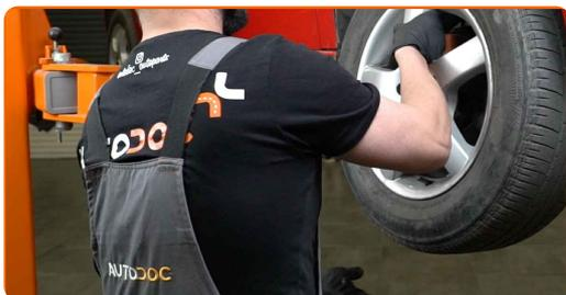
**11** Løsne festet til drivakselen. Bruk en pipenøkkelinnsats #36. Bruk et svingjern.
