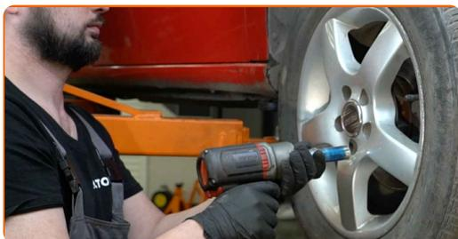
**74** Senk bilen og stram hjulboltene, arbeid på kryss. Bruk en kraftpipe for hjulmutter #17. Bruk en momentnøkkel. Stram den til 120 Nm dreiemoment.
