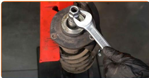
**36** Fjern støtdemperfestet, støvbeskytteren og støtstopperen.
