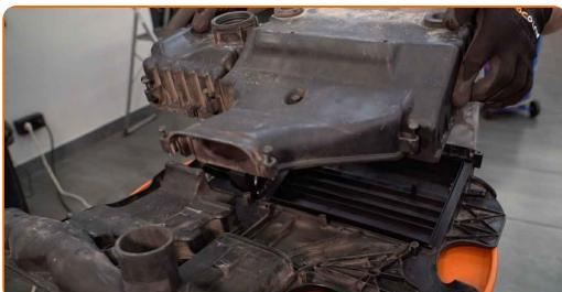
**8** Fjern filterelementet fra filterhuset.
