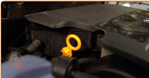
**4** Fjern motordekselet. Luftfilterhus integreres i motordeksel.
