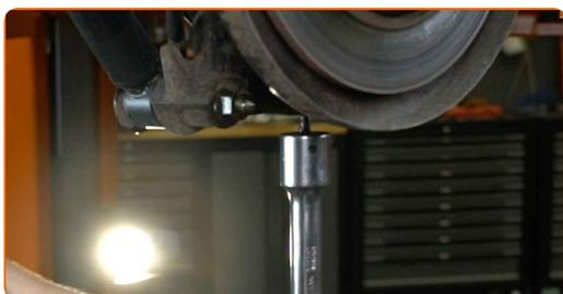
**7** Rengjør det nedre støtdemperfestet. Bruk en stålbørste. Bruk WD-40 spray.
