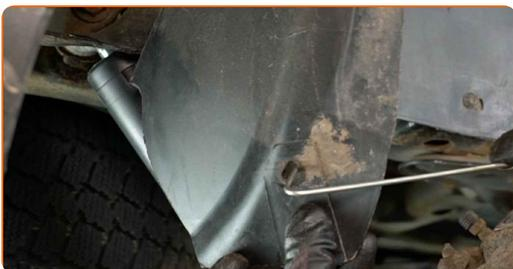
**12** Rengjør det øvre festet til støtdemperen. Bruk en stålbørste. Bruk WD-40 spray.
