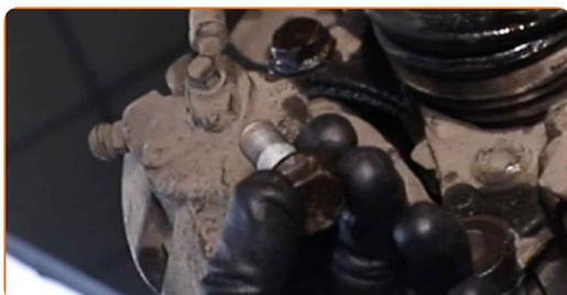
**12** Demonter bremsecaliperen sammen med braketten.
