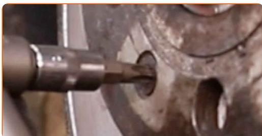
**44** Installer bremsecaliperen sammen med braketten.
