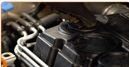
**4** Rengjør oljefilteret. Bruk universal rengjøringspray.
