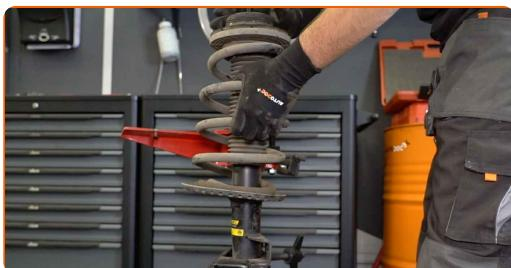
Utskifting: fjærer – VW Transporter T5 Minibuss (7HB, 7HJ, 7EB, 7EJ, 7EF, 7EG, 7HF, 7EC). AUTODOCs eksperter anbefaler:
