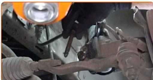
**33** Frigjør nedre feste som kobler fjærbein til styrespindel. Bruk en spesiell pipenøkkel til å fjerne støtdemperen. Bruk en skrallenøkkel.
