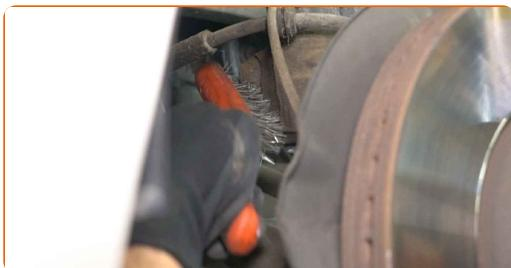
**31** Skru løs festene som kobler fjærbeinet til styrespindelen. Bruk en pipenøkkelinnsats #18. Bruk en skrallenøkkel.
