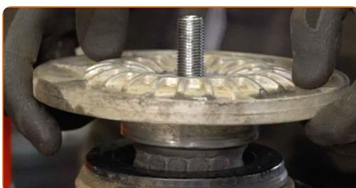
**49**Stram fjærbeinets stempelstangmutter. Bruk en pipenøkkelinnsats #21. Bruk HEX nr. H7. Bruk en momentnøkkel.
