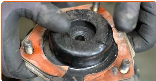
**26** Ta av støtdemper-støvhetten og støtstopperen.
