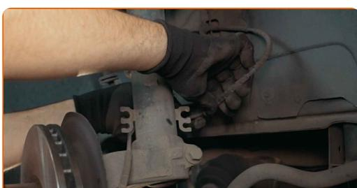
**15** Rengjør det nedre festet som kobler fjærbeinet til styrespindelen. Bruk en stålbørste. Bruk WD-40 spray.
