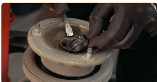
**29** Behandle stangen til fjærbeinet. Bruk en stålbørste. Bruk WD-40 spray.
