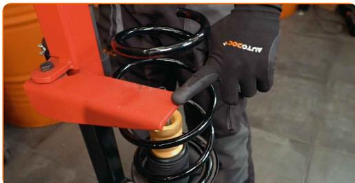
**40** Installer den øvre demperen og monteringslager.
