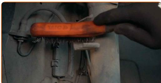
**12** Skru løs festene som kobler stabilisator-ledd til fjærbein. Bruk en pipenøkkelinnsats #16. Bruk en skrallenøkkel.
