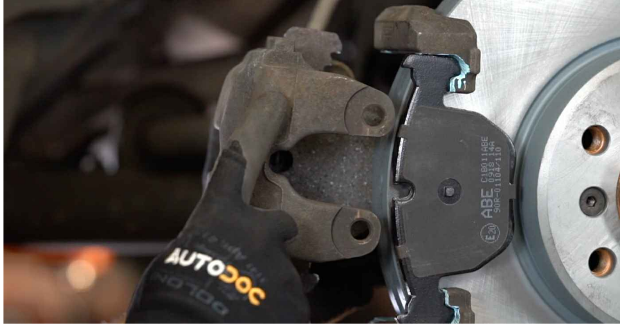
31 Installer hetten til støvmansjetten på føringsstiftene i bremseklaven.
