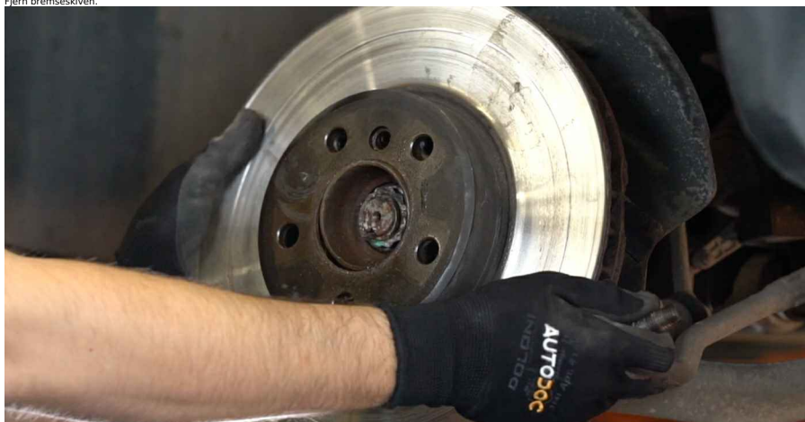
22 Rengjør navet. Bruk en stålborste. Behandle deretter kontaktflaten. Bruk kobberfett.
