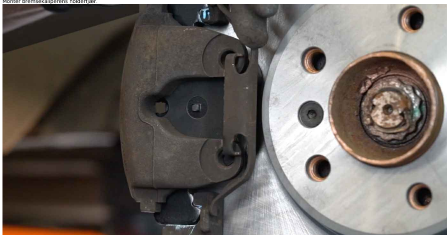
33 Rengjør overflaten av bremsekiven. Bruk bremserens.
