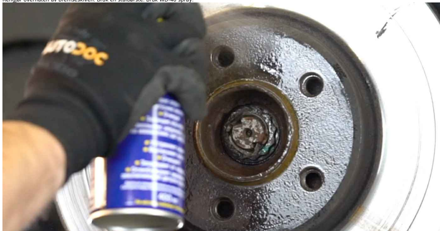
20 Skruløs bremsekivefestet. Bruk Torx T30. Bruk en slagskrutrekker.
