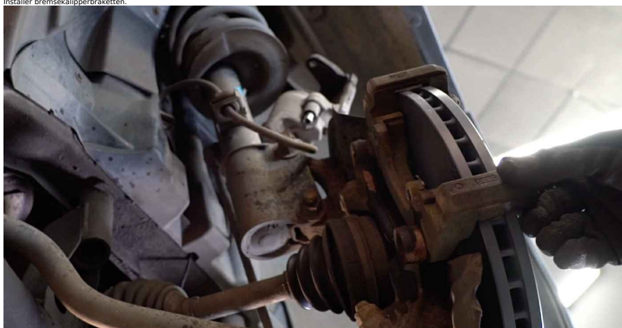
26 Stram bremsekalipperbraketten. Bruk en pipenøkkelinnsats #16. Bruk en momentnøkkel. Stram den til 110 Nm dreiemoment.
