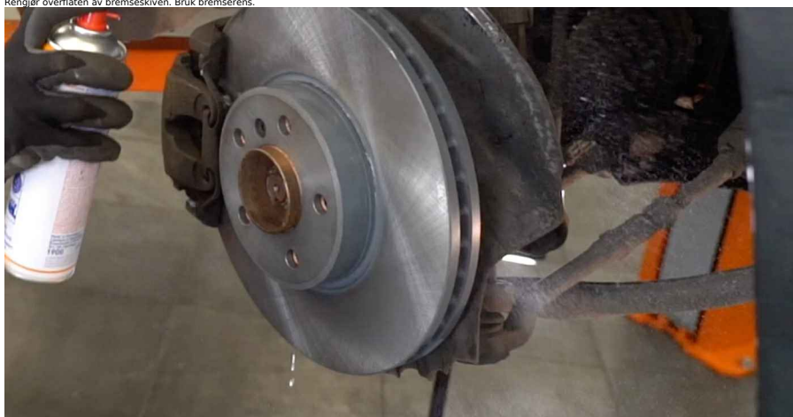
33 Rengjør overflaten av bremsekiven. Bruk bremserens.
