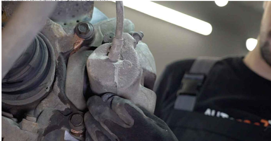
32 Monter bremsekaliperens holderfjær.
