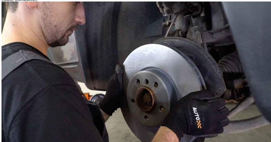
24 Stram bremseskivefestet. Bruk Torx T30. Bruk en momentnøkkel. Stram den til 16 Nm dreiemoment.
