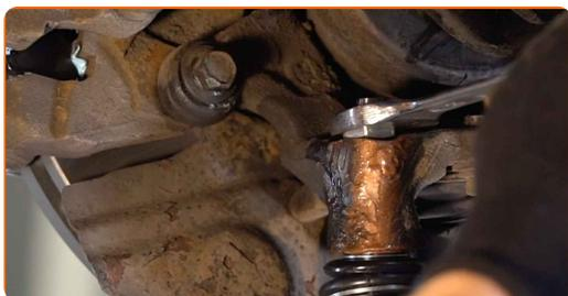
**19** Stram armestet til underrammen. Bruk en pipenøkkelinnsats #18. Bruk en kombinasjonsnøkkel #18. Bruk en momentnøkkel. Stram den til 100 Nm dreiemoment.+90°
