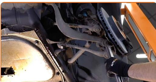
**11** Fjern kuleleddet fra styrespindelen. Bruk et brekkjern.
