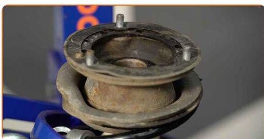
**39** Stram fjærbeinets stempelstangmutter. Bruk en kombinasjonsnøkkel #21. Bruk HEX nr. H7. Bruk en momentnøkkel. Stram den til 60 Nm dreiemoment.
