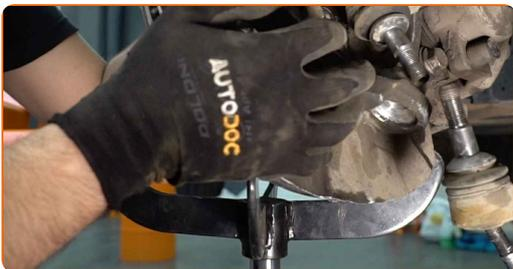
**54** Stram nedre fester som kobler fjærbein til styrespindel. Bruk en kombinasjonsnøkkel #22. Bruk en pipenøkkelinnsats #22. Bruk en momentnøkkel. Stram den til 250 Nm dreiemoment.
