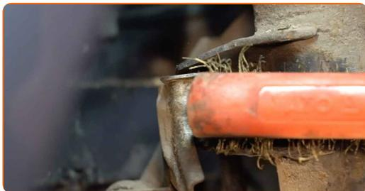
**11** Skru løs nedre feste som kobler fjærbein til styrespindel. Bruk en kombinasjonsnøkkel #22. Bruk en pipenøkkelinnsats #22. Bruk en skrallenøkkel.
