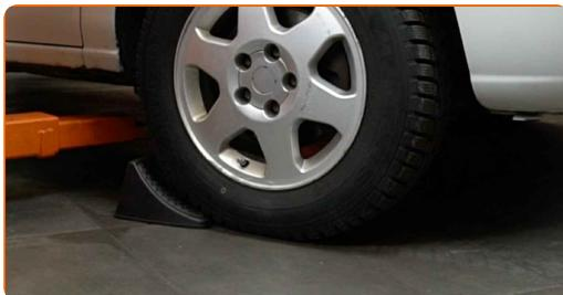
2 Løsne hjulfesteboltene. Bruk en kraftpipe for hjulmutter #19.
