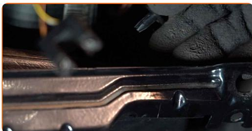
**10** Ta bort luftfilterkanalen fra luftfilterhuset.
