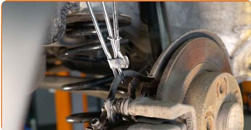
**10** Skru bremseslangen løs fra bremsekaliperen. Bruk en kombinasjonsnøkkel #11.
